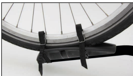
Obr. 15: Utažení popruhů na předním kole
